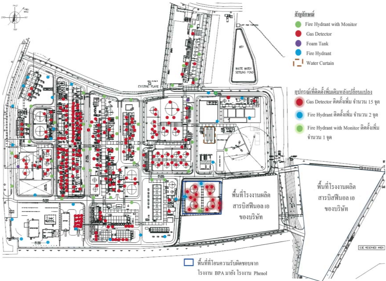
รูปที่ 2.8.4-1 ตำแหน่งของระบบป้องกันและระบบอัคคีภัย โครงการโรงงานผลิตสารฟีนอล บริษัท พีทีที ฟีนอล จำกัด
